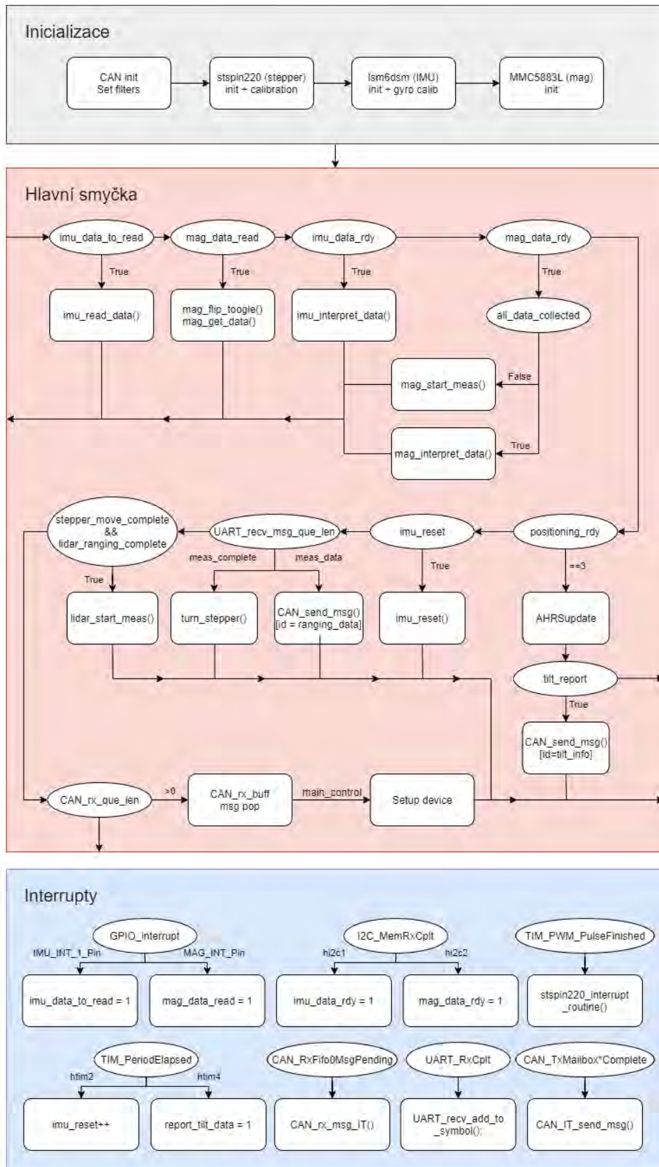
Obrázek 4.14: Lidar: Procesní diagram programu spodního MCU
