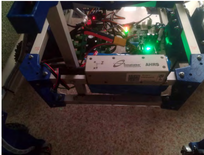
Obrázek 10.7: Testování: Připevnění referenční AHRS jednotky.
