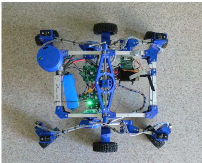
Obrázek 5.7: Motor Board: Natočení kol při klasickém režimu
