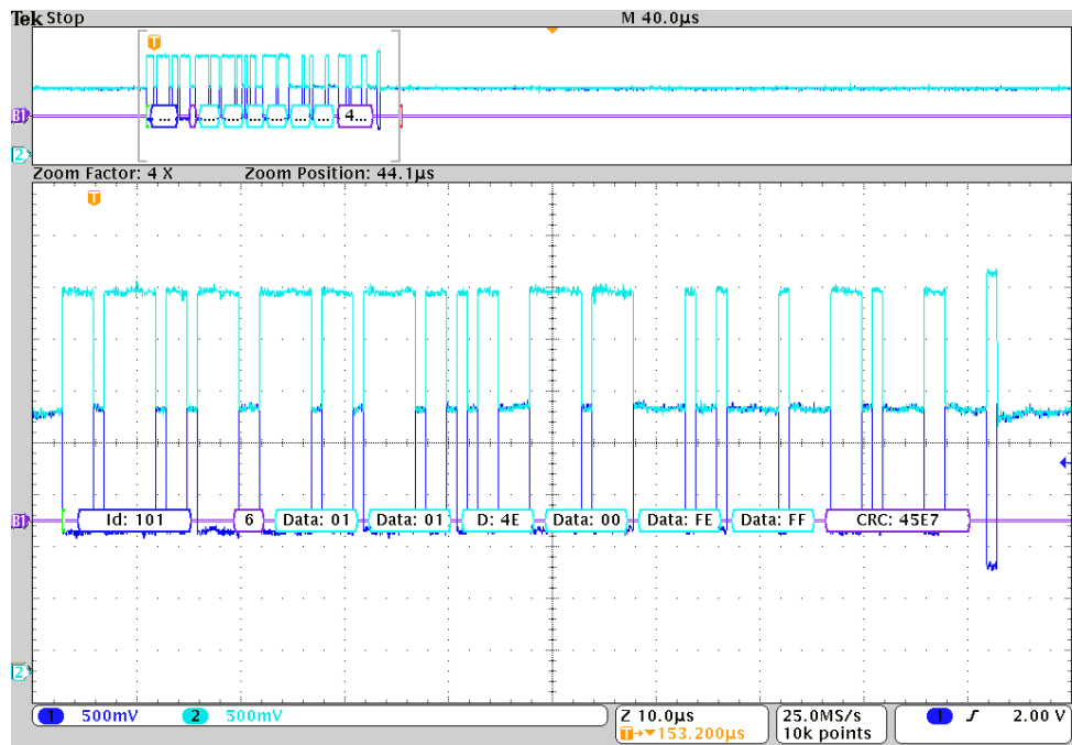
Obrázek 7.1: CAN bus: Ukázka rámce MotorBoard_set_drive_status
