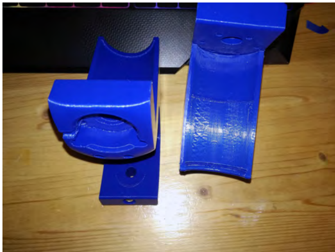
Obrázek 11.4: Závěr: Vytiskuté klouby pro uchycení motoru s kolem
