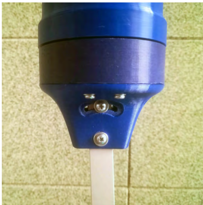
Obrázek 9.1: Stavba robota: Detail uchycení Lidaru.
