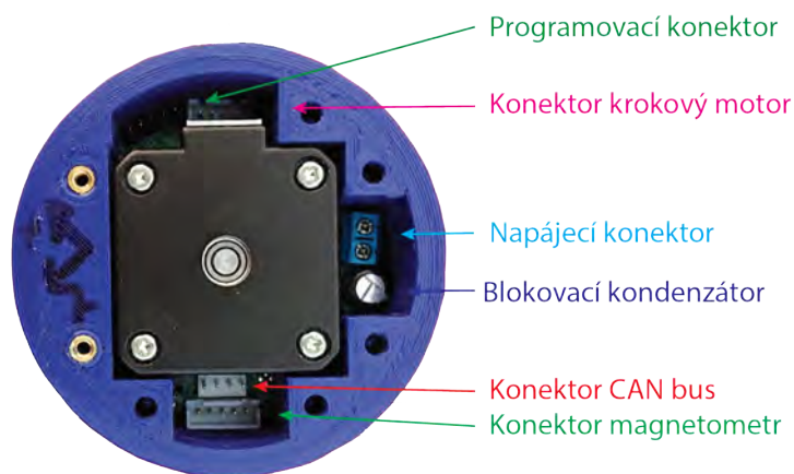
Obrázek 4.12: Lidar: Detail na rozvržení konektorů kolem stěn krokového motoru
