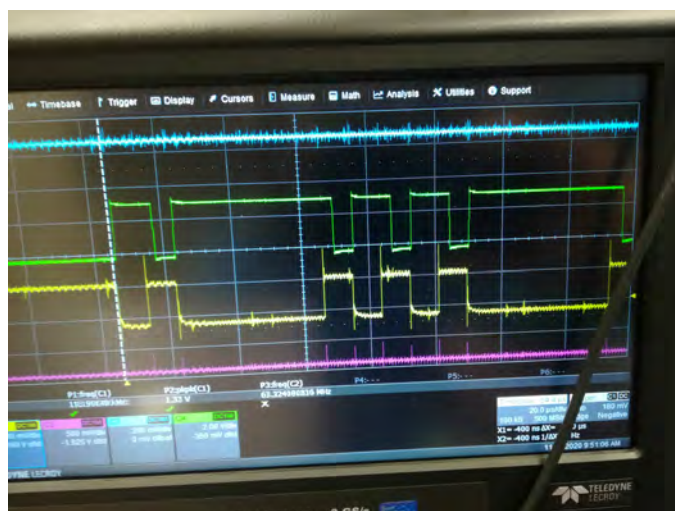
Obrázek 11.6: Závěr: Testování přenosu UARTu. Je zde pozorovatelný problém se zpožděním sestupné hrany, který bylo potřeba potlačit.
